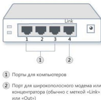
*Рис. 1. Концентратор Ethernet*
