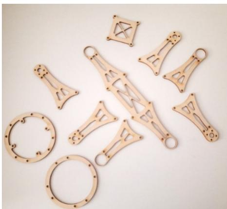
*Рис. 1 Детали рамы, изготовленные на станке с ЧПУ Cutter ML*
