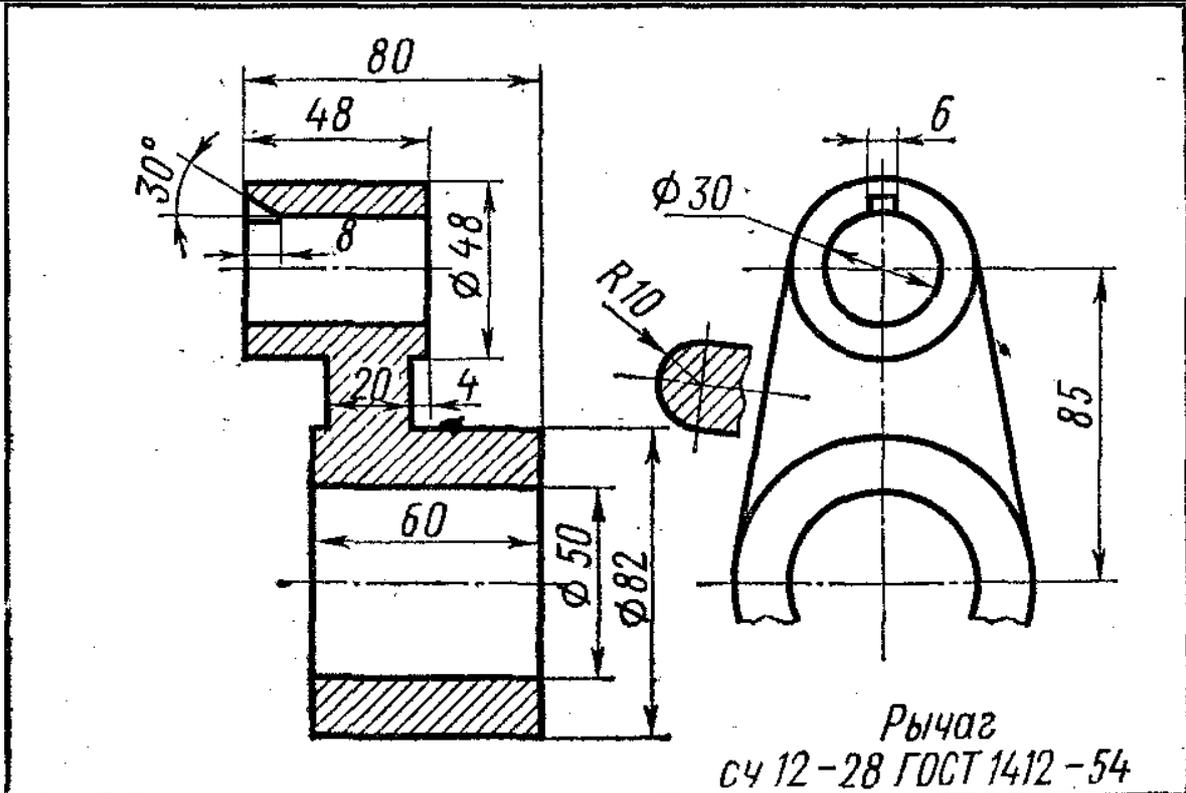
**Задание:** Фрезерование плоскости на размер 60 мм.
