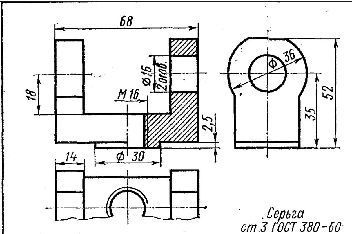
**Задание:** Фрезерование поверхности на размер 52 мм.
